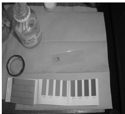
Figura 2. Tiras reactivas clásicas para determinación del pH
