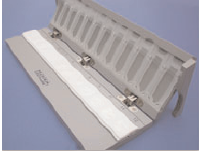
Fig 1 - Visão interna do equipamento prepene. Na parte superior, vê-se a posição das lâminas
