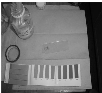
**Figura 2.** Tiras reactivas clásicas para determinación del pH
